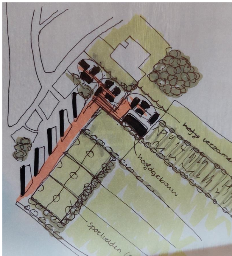
Principe 2: boerderijerven, kleine gebouwen (2-3 lagen), vormgegeven als 2-onder-1 kap of dergelijke, die opgesplitst zijn in kleinere (tot 6) woningen
