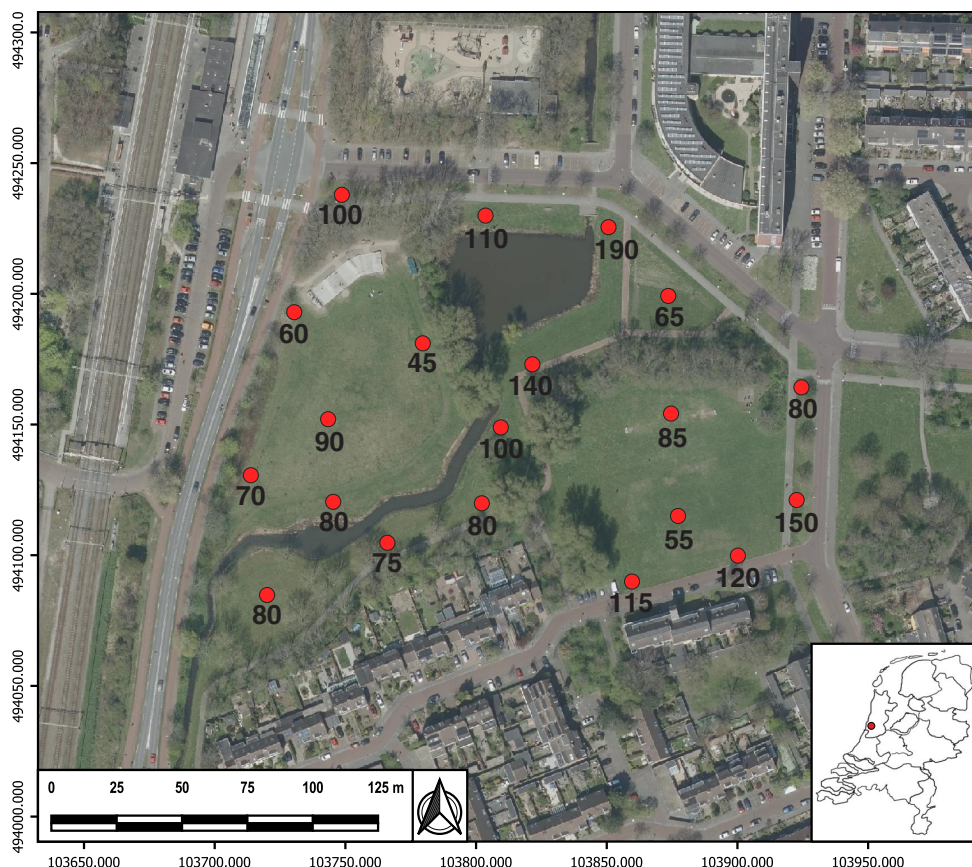
Afbeelding 15. Boorpuntenkaart met de diepte van de recente verstoringen weergegeven naast de boringen.
